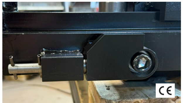
Ripustettavan asetinlaitteen pikakiinnitys
